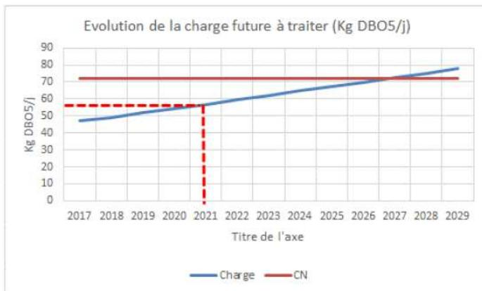
Globalement, la capacité nominale de traitement de la station d'épuration serait dépassée à l'horizon 2026/2027 et 80% de cette capacité serait atteinte dès 2021. Ce seuil correspond à la charge maximale effectivement admissible pas la station d'épuration pour garantir un fonctionnement encore satisfaisant (par temps sec tout au moins)
